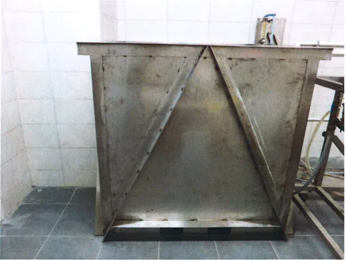
Immersion Tank (Daldırma Tankı)
